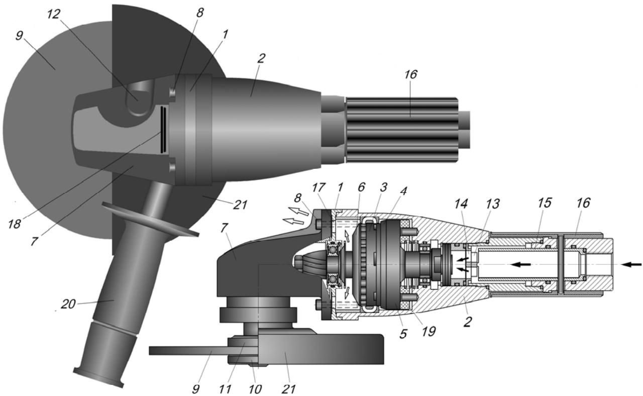
При повороте рукоятки против часовой стрелки (взгляд на машину со стороны ПУ) воздух поступает в турбинное колесо 3, где передает свою энергию ротору. В процессе работы машины регулятор 4 обеспечивает стабильность частоты вращения при изменяющейся нагрузке на инструмент. Отработавший воздух выходит из машины в направлении оси вращения привода через окна 17 среднего корпуса 1 и окна 18 переднего корпуса 7.
